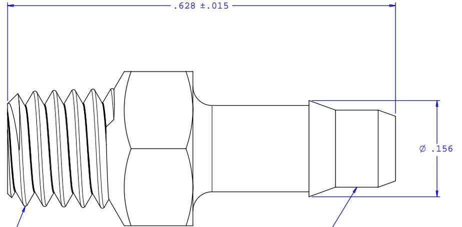
INSTRUMENT QUALITY PART. NO PARTING LINE PERMITTED ON THIS CONICAL SURFACE
