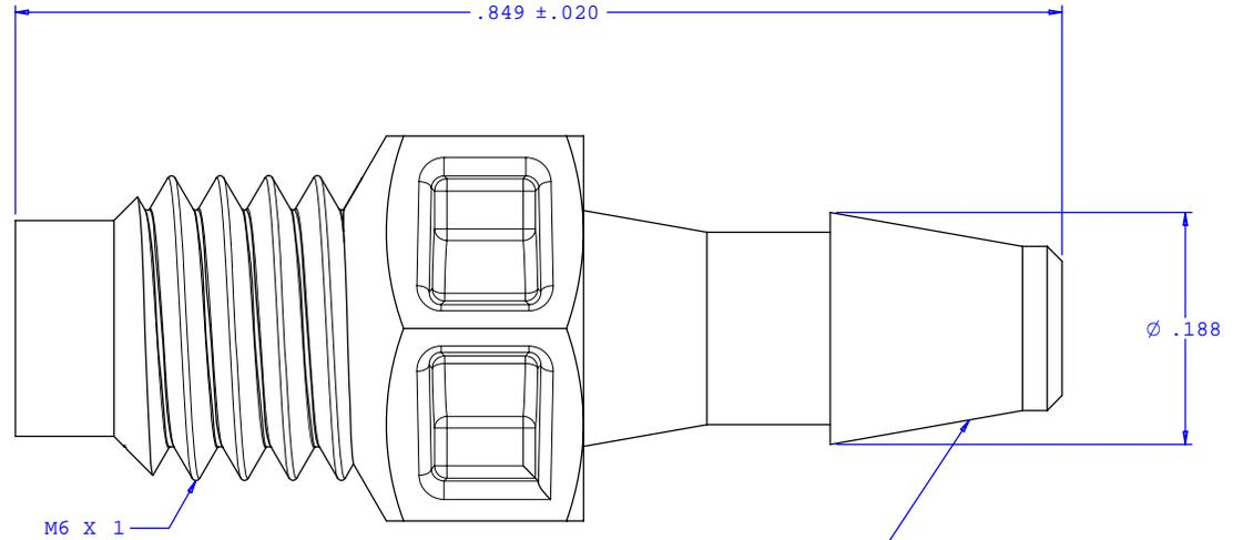
INSTRUMENT QUALITY PART. NO PARTING LINE PERMITTED ON THIS CONICAL SURFACE
